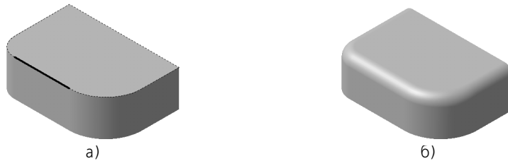
Рис. 83.2. Скругление: а) для построения скругления указано одно ребро и включена опция Продолжать по касательной , б) результат построения скругления
