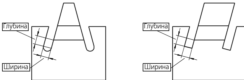
Рис. 89.19. Определение размеров освобождения сгиба при отличном от нуля угле на сгибе
