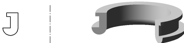
Рис. 76.4. Эскиз и элемент, образованный операцией вращения
