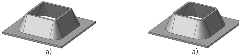
Рис. 93.5. Открытая штамповка с уклоном боковых стенок и скругленными боковыми ребрами: а) радиус скругления равен нулю, б) радиус скругления больше нуля
