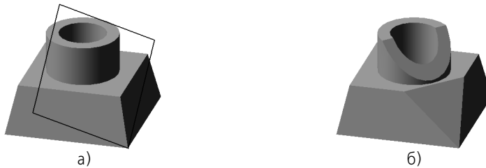
Рис. 84.1. Отсечение части детали плоскостью: а) исходное состояние детали (плоскость отсечения обозначена условно), б) результат выполнения операции отсечения
