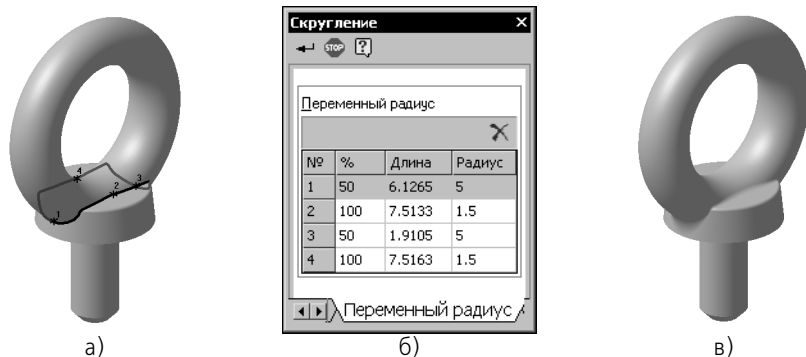
Рис. 83.4. Построение скругления с переменным радиусом: а) указание точек, б) задание параметров скругления, в) результат выполнения команды
