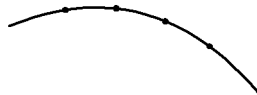
Рис. 10.4. Пример простановки трех точек вдоль дуги на расстоянии 5 мм от базовой точки
