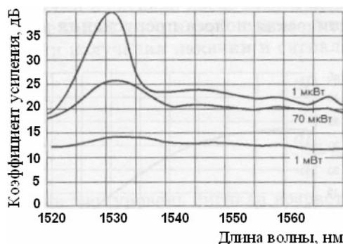
Рис. J.7. Зависимость усиления от длины волны при различных уровнях входного сигнала.
