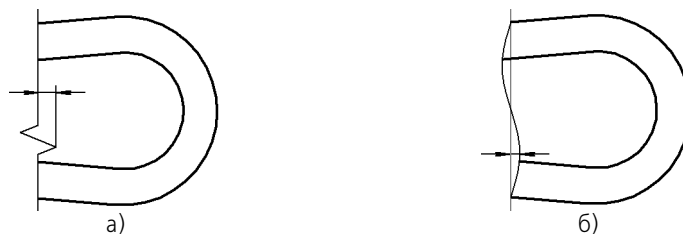
Рис. 48.6. Амплитуда: а) линии с изломом, б) волнистой линии (серым цветом показана средняя линия)
