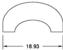
текст центрирован по вертикали относительно размерной линии
