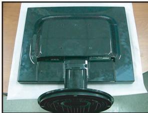
2. Z izvijačem ločite stojalo, kot kaže slika.
