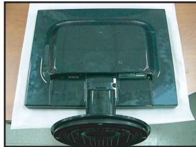
2. Χωρίστε τη βάση χρησιμοποιώντας ένα κατσαβίδι, όπως φαίνεται στην εικόνα.
