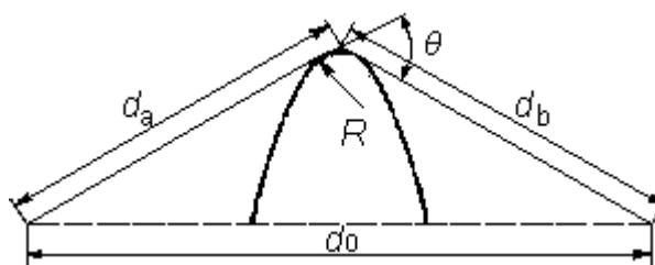
Рис. 1.5. Геометрические параметры препятствия.
