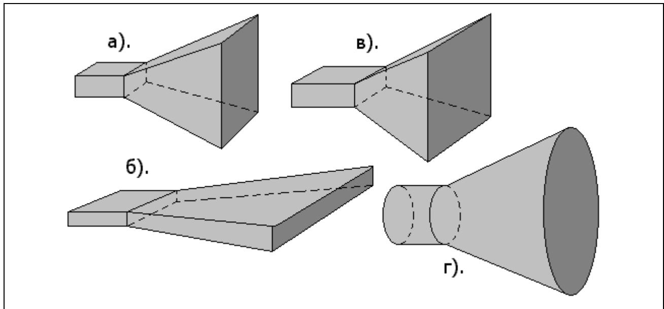
Рис. 1.1. Типы рупорных антенн:
