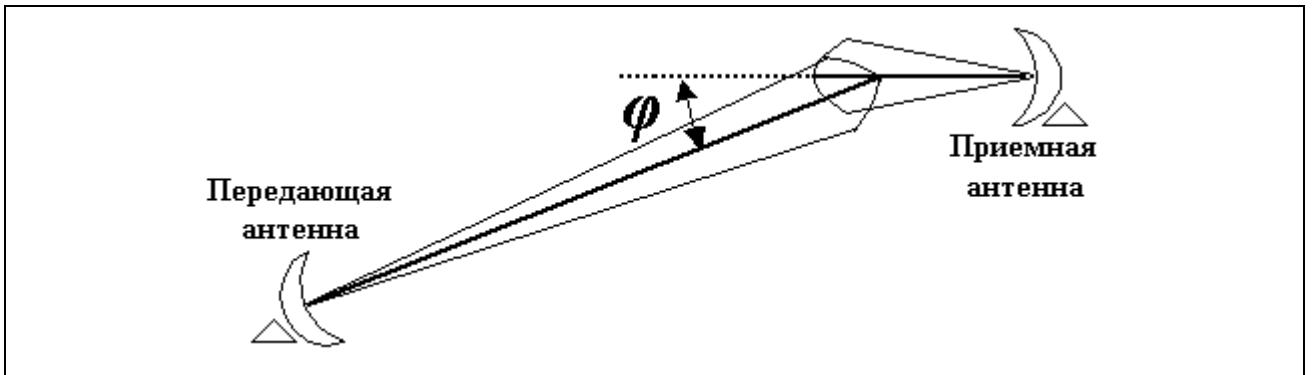
Рис. 1.3. Пример взаимного расположения приемной и передающей антенн.
