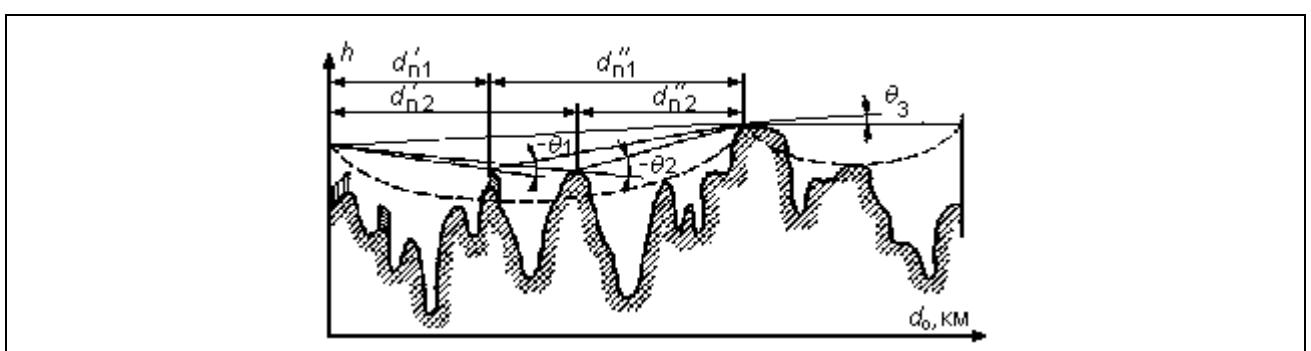
Рис. 1.7. Геометрические параметры препятствий с  $\theta < 0$ .
