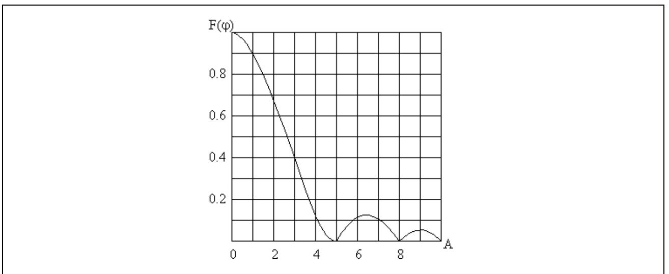
Рис. 1.4. Нормированная диаграмма направленности антенны с параболическим рефлектором.
