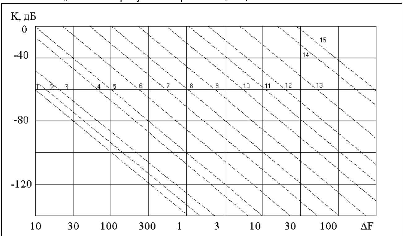
Рис. 1.9. Коэффициент коррекции из-за разности частот между приемником и передатчиком.
