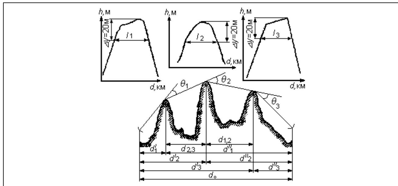
Рис. 1.6. Геометрические параметры трассы с несколькими препятствиями.
