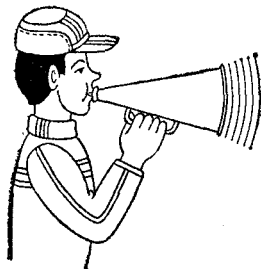
Рис. 82. Рупор (мегафон) дает направленное излучение
