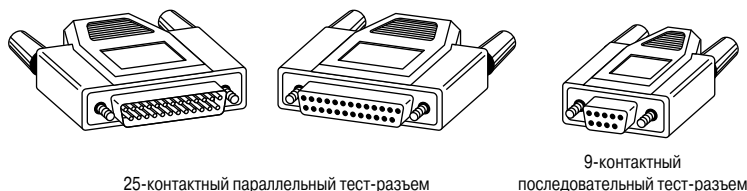
Рис. 23.6. Внешний вид типичных 9- и 25-контактных тест-разъемов
