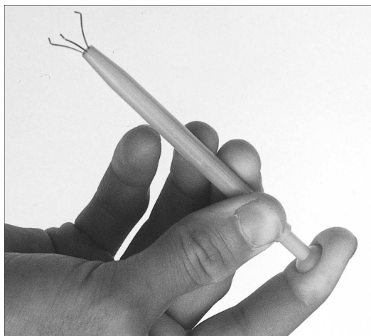
Рис. 23.3. Зажим, с помощью которого удерживают и извлекают небольшие детали
