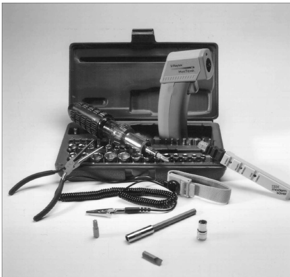
Рис. 23.1. Набор инструментов, который желательно иметь под рукой при работе с компьютером
