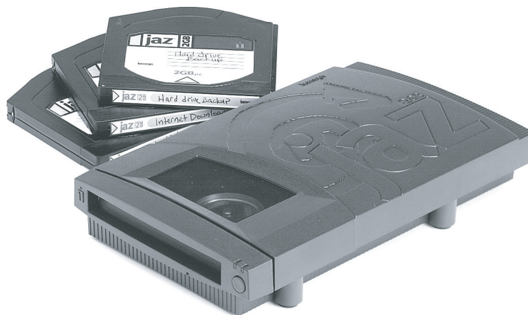
Рис. 12.4. Внешний дисковод Jaz 2 Гбайт и носитель
