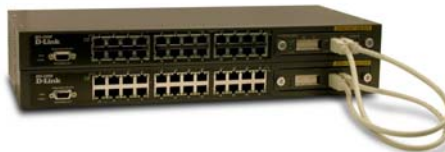
Рисунок 5. Стек на коммутаторах DES-3326S
