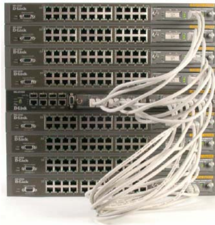
Рисунок 7. Стек типа «звезда» на коммутатора DGS-3212SR (в центре) и DES-3226S
