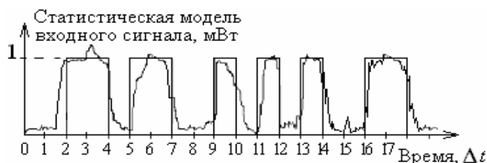
Рис. 5.4. Статистическая модель цифрового сигнала с учетом шума, джиттера и ДВИ в канале передачи E1. Ровными линиями представлен идеальный сигнал в коде СМІ (с инверсией комбинаций) [18]
