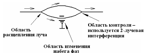
Рис. 4.31. Схема коммутационного элемента, в основу работы которого заложен электрооптический эффект Поккельса и двухлучевая интерференция
