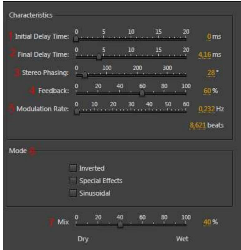
**Initial Delay Time** (начальное время задержки) - устанавливает точку в миллисекундах, на которой начинается флэнжер после исходного сигнала. Эффект фленжера наступает при изменении времени задержки в течение долгого времени от начального значения задержки до второго (или конечного) значения задержки.
