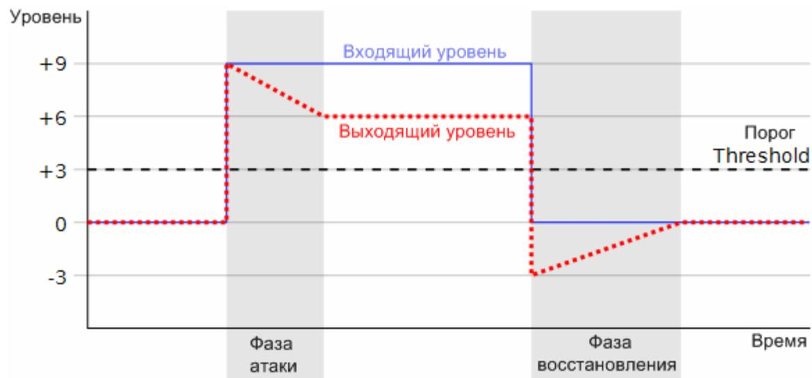
Компрессор уменьшает уровень звукового сигнала, если его амплитуда превышает определенный порог (**Threshold**). Сила подавления определяется соотношением (**Ratio**): соотношение 4:1 означает, что если уровень входного сигнала превышает порог (0 дБ) на 4 дБ, то уровень выходного сигнала будет = 1 дБ. Уровень был сокращён в 4 раза (на 3 дБ):
