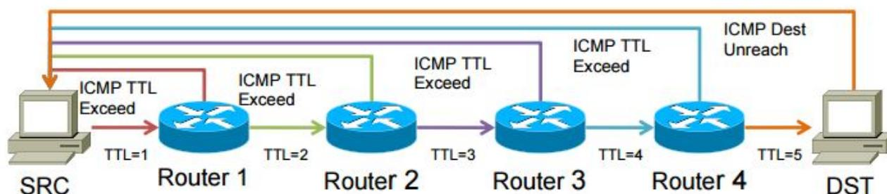
Клиент посылает ICMP на узел назначения, точно также, как и при ping, но TTL выставляется в единичку. Первый маршрутизатор, получив сообщение, отбрасывает ICMP-сообщение, в ответ генерирует ICMP-сообщение об ошибке (TTL истекло), с указанием собственного IP-адреса в качестве адреса отправителя (его мы и видим в выдаче).
