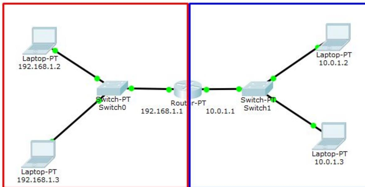
Для этого примера достаточно поднять сетевые интерфейсы на маршрутизаторе, а на клиентах прописать соответствующие IP-адреса маршрутизатора.
