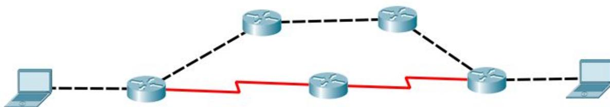
**Протоколы вектора расстояния (Distance vector)** — также называемые дистанционно векторными, используют алгоритм кратчайшего пути для поиска маршрута до удаленной сети. Каждый переход (перенаправление) пакета с помощью маршрутизатора называют хопом (HOP). Протоколы этого типа вычисляют маршрут согласно количеству переходов без учета производительности канала. Примерами таких протоколов являются: RIP, IGRP.
