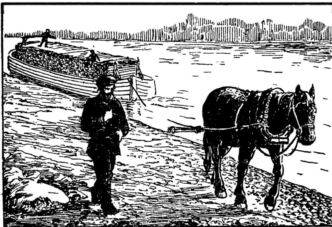
Рис. 10. Самый дешевый транспорт — водный. На воде лошадь может везти груз в 30 раз больший, чем на мостовой.
