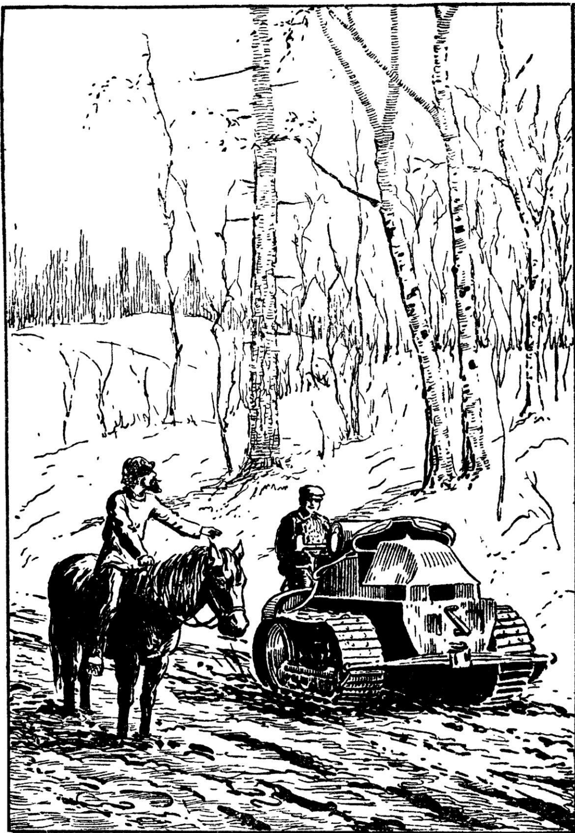
Рис. 6. Почему гусеничный трактор не проваливается там, где увязает лошадь?
