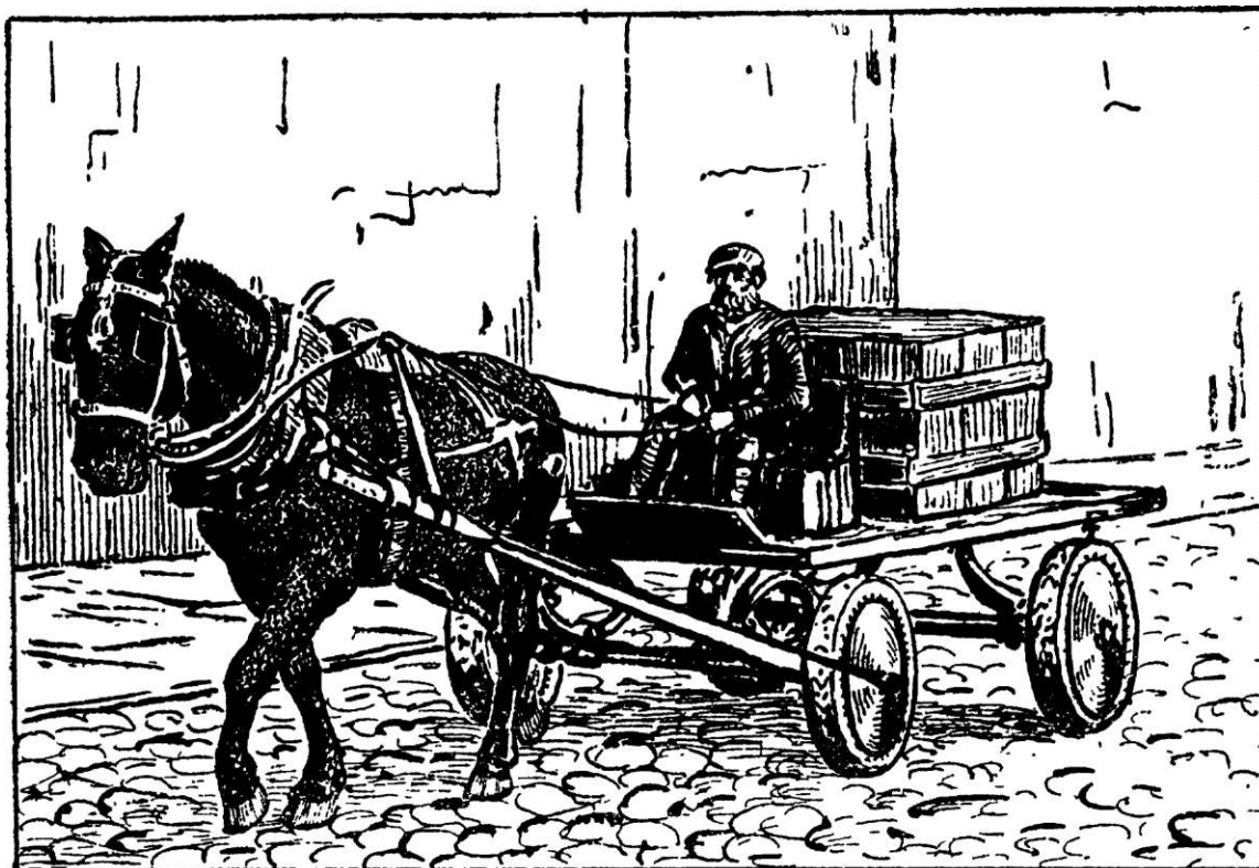
Рис. 8. Чтобы везти телегу по булыжной мостовой, сила тяги лошади должна составлять около 30-й доли веса клады вместе с телегой.
