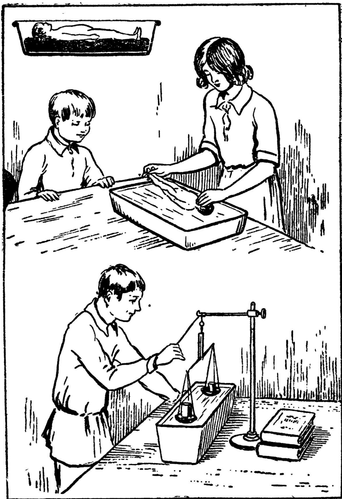
Рис. 35. Выталкивающее действие жидкости. Вверху — восковая куколка, плавающая в ртути и в воде. Внизу — опыт с весами под водой.
