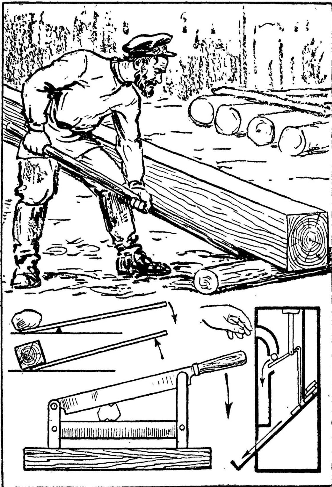
Рис. 17. Как работает рычаг. Вверху — подъем тяжелого бруса рычагом второго рода; внизу — колка сахара рычагом (какого рода?). В правом углу внизу — устройство билетного автомата.
