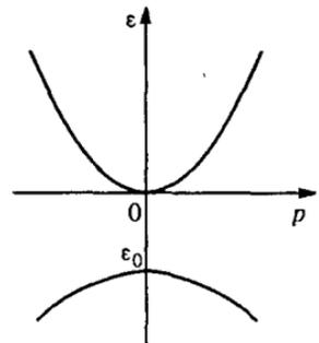
Рис. 112. Зависимость энергии электронов зоны проводимости и валентной зоны от квазиимпульса
