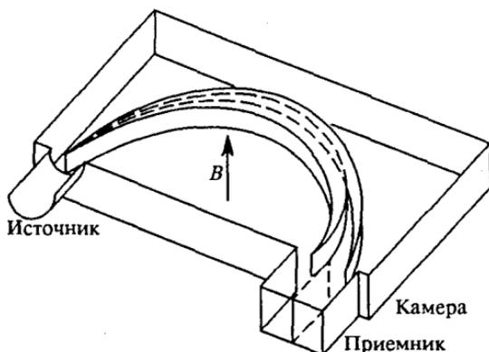
Рис. 31. Схема электромагнитной разделительной установки
