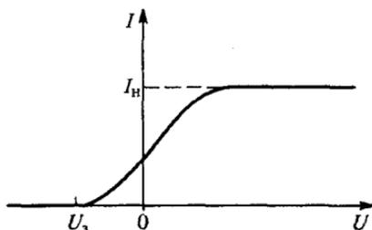
Рис. 17. Зависимость силы фототока от приложенного напряжения при неизменном световом потоке
