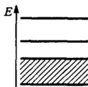
Рис. 109. Схема энергетических зон кристалла
