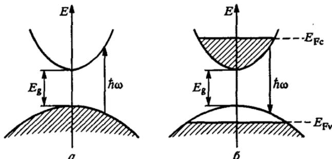
Рис. 122. Схема энергетических зон в кристаллах  $A^3B^5$ . На рис. *a* показано равновесное распределение электронов по уровням энергии, при котором свет поглощается, а на рис. *б* — сильно неравновесное распределение электронов с инверсией заселенностей, необходимое для усиления света
