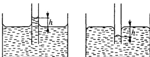
Рис. 84. Жидкость в капиллярах
