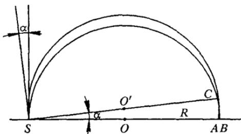
Рис. 28. Фокусировка поперечным однородным магнитным полем
