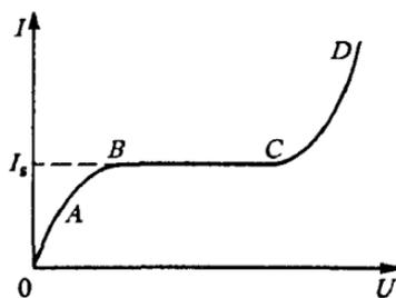
Рис. 103. Экспериментальная вольт-амперная характеристика газового разряда
