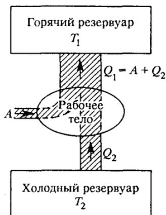
Рис. 62. Принципиальная схема холодильной машины
