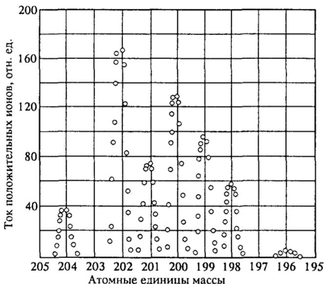
Рис. 32. Спектр масс изотопов ртути
