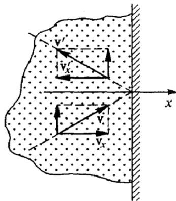
Рис. 66. Упругое столкновение молекулы газа со стенкой сосуда
