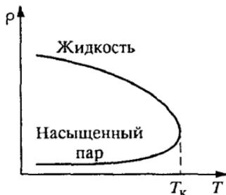
Рис. 80. Зависимость плотности жидкости и ее насыщенного пара от температуры
