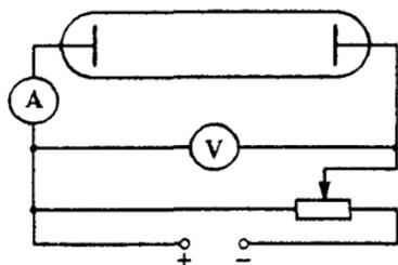
Рис. 102. Схема установки для изучения газового разряда
