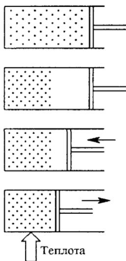
Рис. 79. Один из вариантов «вечного» двигателя второго рода
