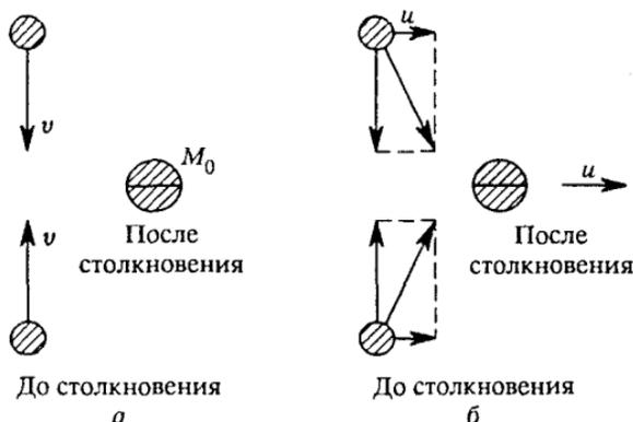
Рис. 11. Неупругое столкновение, наблюдаемое в разных системах отсчета
