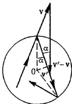
Рис. 68. Столкновение молекулы газа со стенкой сферического сосуда
