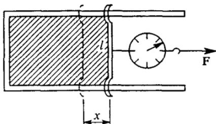
Рис. 82. К вычислению работы при увеличении поверхности пленки
