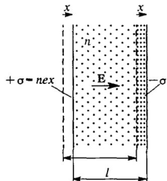
Рис. 108. К выводу формулы для частоты плазменных колебаний
