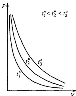
Рис. 46. Изотермы газа на  $p$ — $V$ -диаграмме
