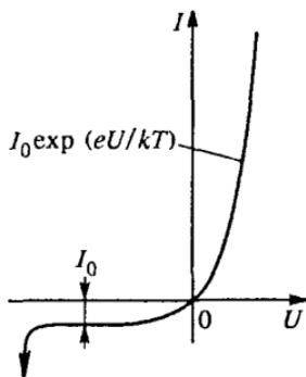
Рис. 120. Вольт-амперная характеристика  $p-n$ -перехода
