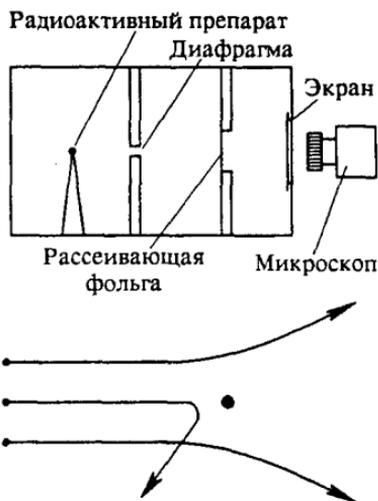
Рис. 24. Схема опытов Резерфорда
