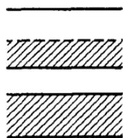
Рис. 110. В металле зона проводимости заполнена электронами частично
