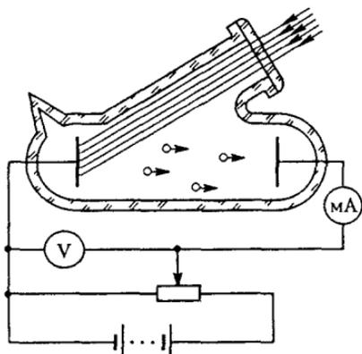
Рис. 16. Схема экспериментальной установки для изучения фотоэффекта
