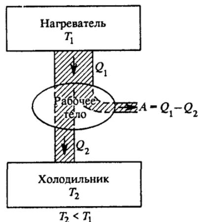
Рис. 53. Принципиальная схема тепловой машины
