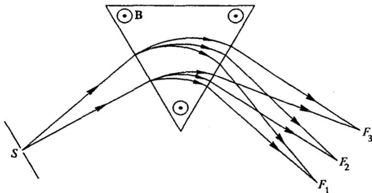
Рис. 27. Схема масс-спектрометра с фокусировкой однородным магнитным полем
