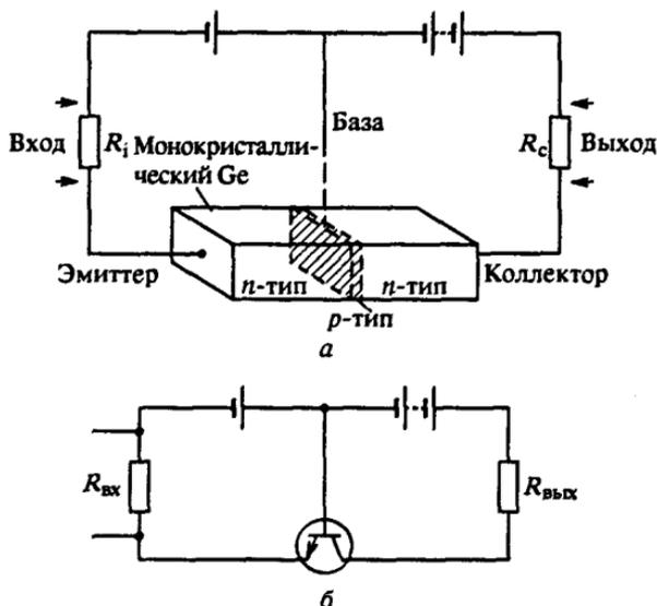
Рис. 121. Схематическое изображение транзистора, в котором две  $n$ -области монокристалла разделены узкой областью с проводимостью  $p$ -типа (а) и условное изображение такого транзистора на электрических схемах (б)
