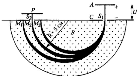
Рис. 30. Схема масс-спектрометра Демпстера
