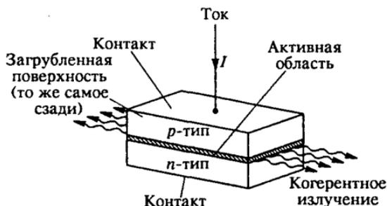
Рис. 123. Схема устройства полупроводникового лазера
