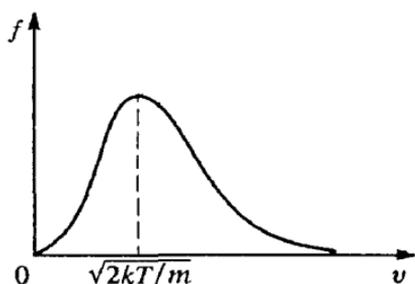
Рис. 74. График максвелловского распределения молекул газа по скоростям
