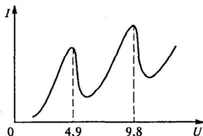
Рис. 105. Зависимость тока от ускоряющего напряжения в опытах
