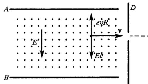
Рис. 29. Схема фильтра скоростей заряженных частиц
