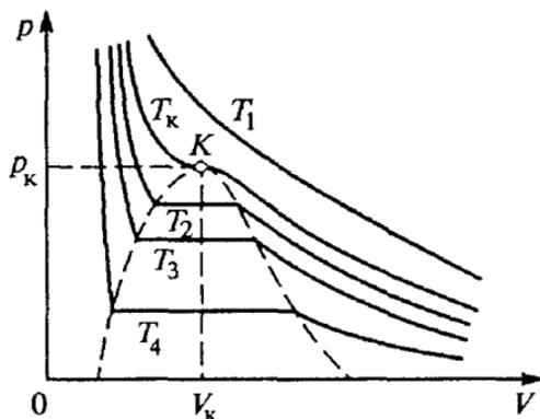
Рис. 86. Экспериментальные изотермы углекислого газа
