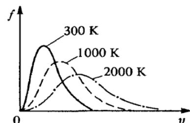
Рис. 75. Функции распределения молекул газа по скоростям при разных температурах
