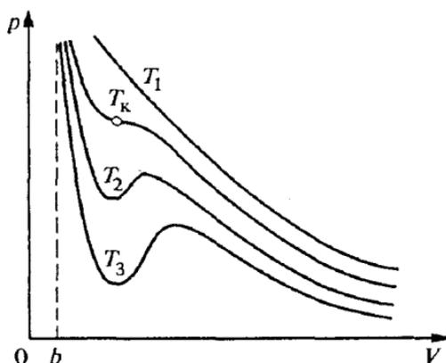
Рис. 85. Изотермы газа Ван-дер-Ваальса на  $p$ - $V$ -диаграмме
