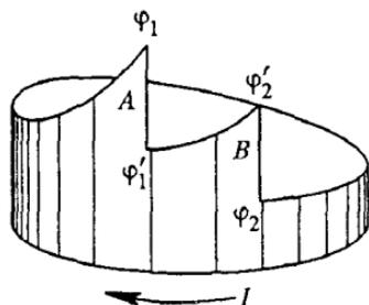
Рис. 107. Распределение потенциала вдоль цепи, содержащей химический элемент
