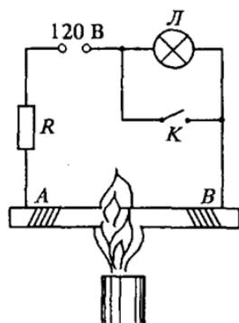
Рис. 106. Демонстрация электропроводности стекла при нагревании
