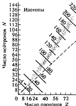
Рис. 124. Число протонов и нейтронов в стабильных ядрах
