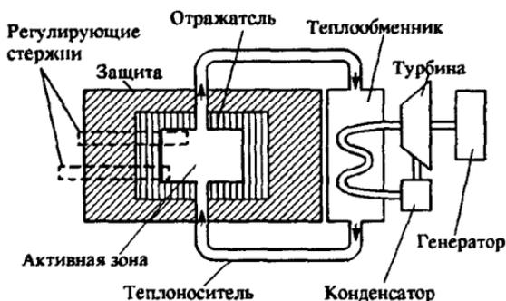
Рис. 126. Схема энергетического ядерного реактора
