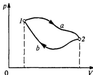
Рис. 54. Цикл теплового двигателя на  $p$ - $V$ -диаграмме
