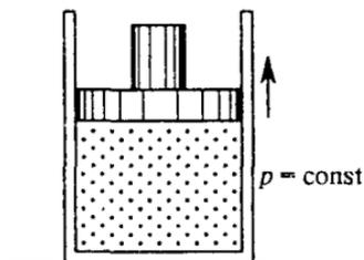
Рис. 51. Изобарическое нагревание газа
