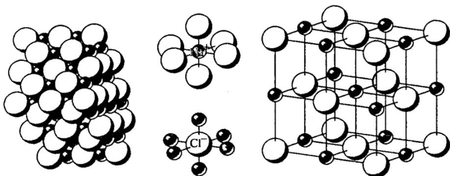
Рис. 37. В кубической решетке кристалла  $\text{NaCl}$  каждый ион натрия или хлора окружен шестью ионами противоположного знака
