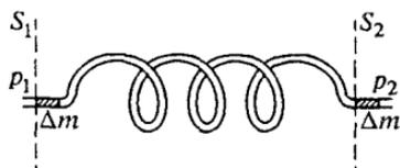
Рис. 55. Прохождение газа через змеевик
