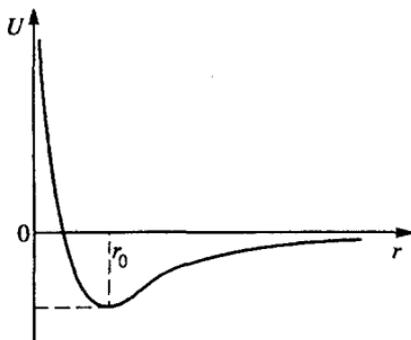
Рис. 36. Зависимость потенциальной энергии взаимодействия атомов в двухатомной молекуле от расстояния между ними
