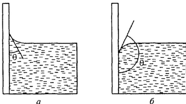
Рис. 83. Краевой угол в случае смачивания (а) и несмачивания (б)
