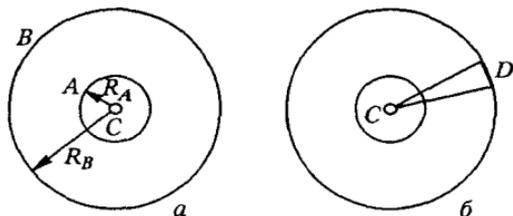
Рис. 76 Схема опытов Штерна
