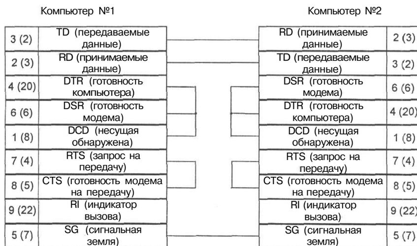
Рис. 2.2 Схема распайки кабеля простого нульмодема для COM-порта (минимальный вариант)
