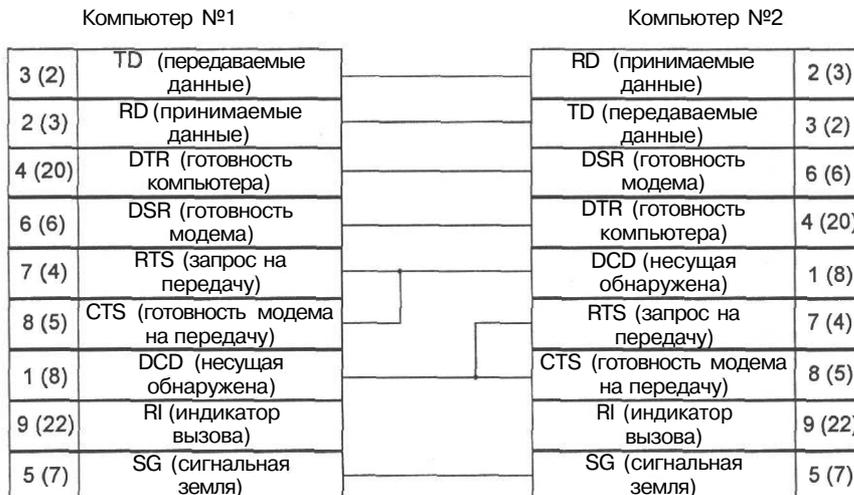
Рис. 2.3 Схема распайки кабеля стандартного нульмодема для COM-порта
