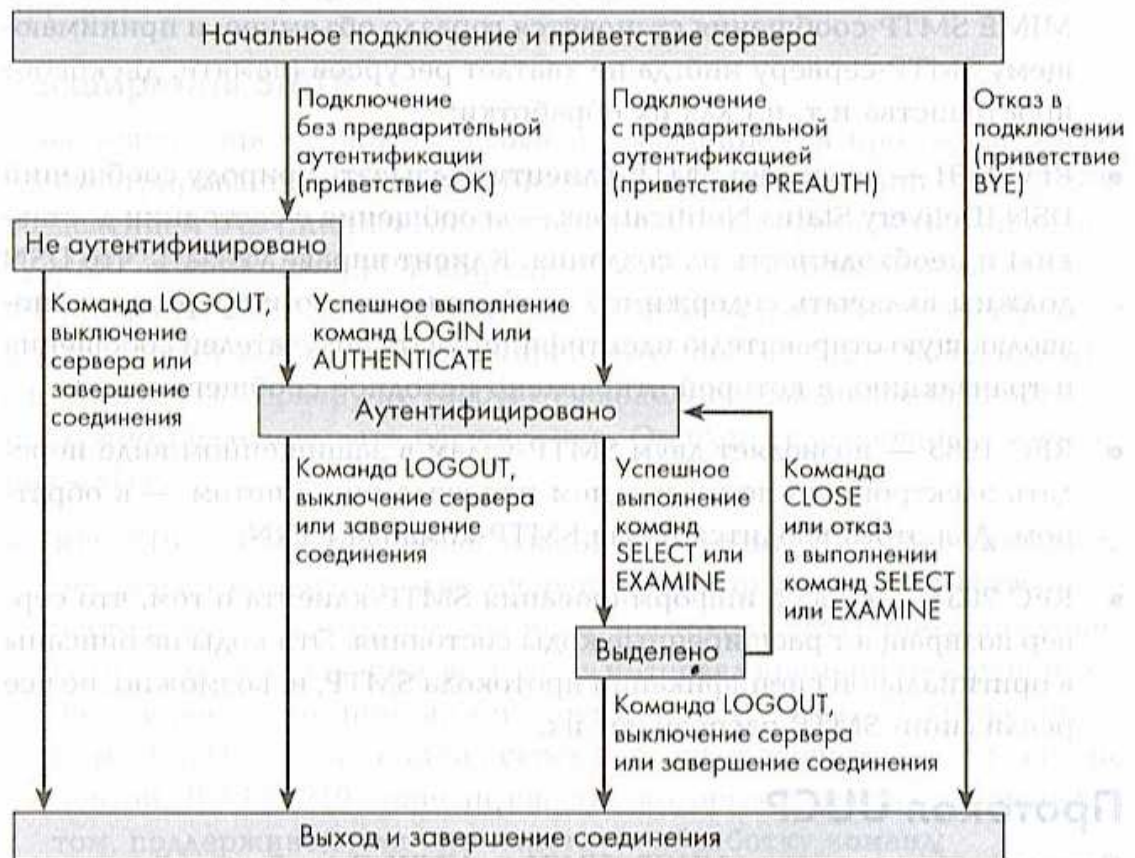
Рис. 9-3. Конечный автомат IMAP согласно описанию в RFC 2060
