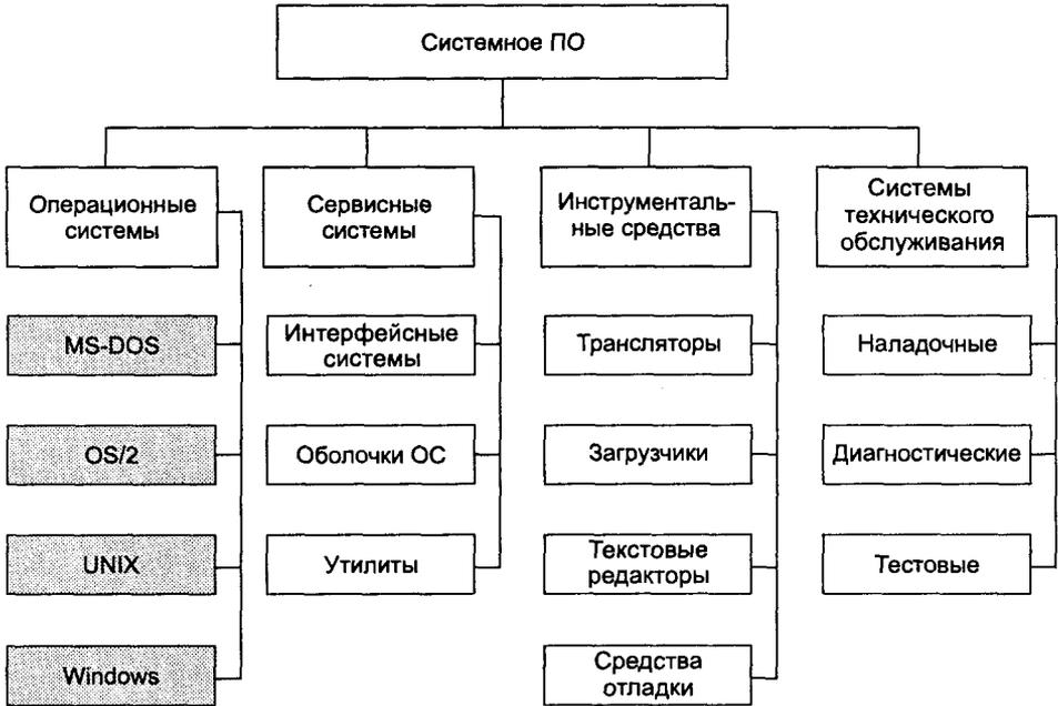
Рис. 10.1. Состав системного программного обеспечения
