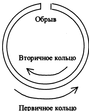
Рис. 3.19. Сворачивание колец FDDI в случае обрыва
