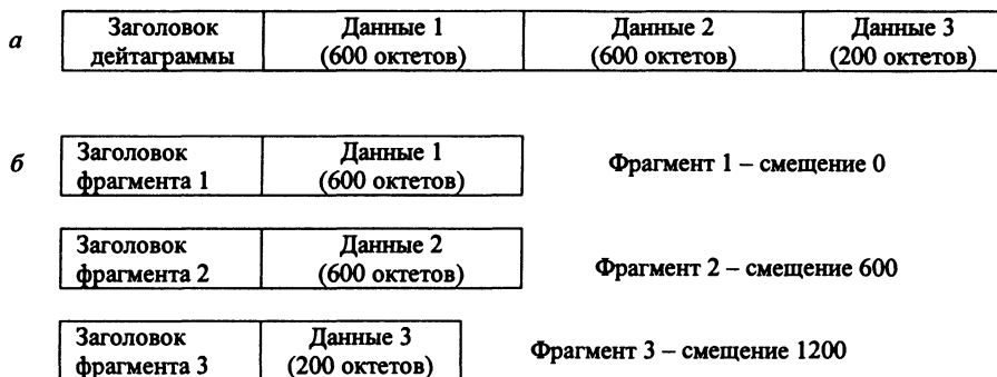
Рис. 5.20. Исходная дейтаграмма, несущая 1400 октетов данных ( a ) и три фрагмента для сети с MTU= 620 ( б )
