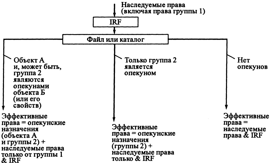
Рис. 8.53. Схема определения ОС NetWare эффективных прав объекта А к объекту Б (или его свойствам):
