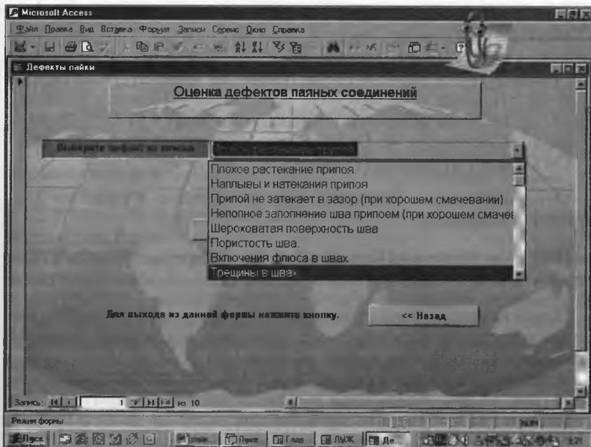
Рис. 18.11. Форма выбора вида дефекта паяного соединения
