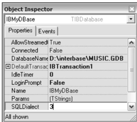
**Рис. 7.43.** Установка свойств компонента `IBDatabase`
