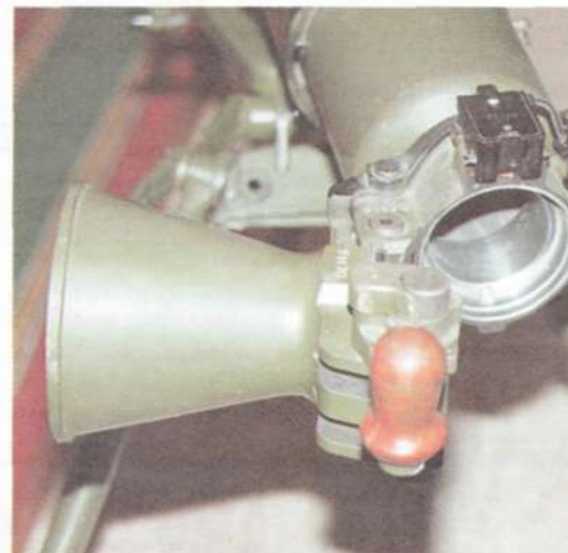
Затвор СПГ-9М в открытом положении.
