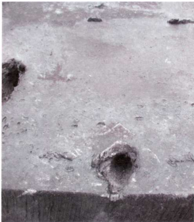
Броня современного танка, пробитая кумулятивными гранатами. На левом фото входные отверстия, на правом фото выходные отверстия.
