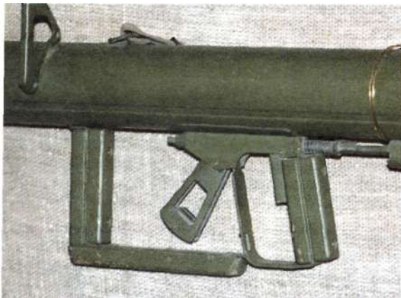
Рукоятка взведения спускового механизма и спусковой механизм ружья «Офенрор».
