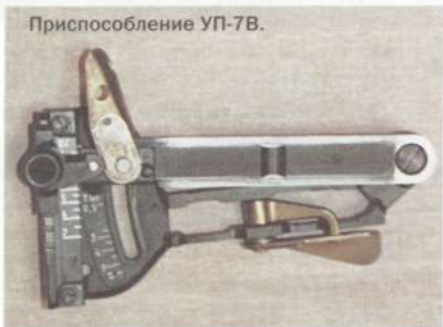
Приспособление УП-7В на гранатомете РПГ-7В2.
