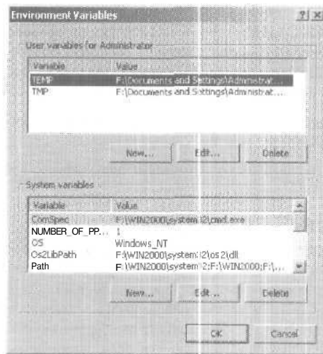
Рис. 2-8. Диалоговое окно Environment Variables позволяет конфигурировать переменные среды для системы и пользователя.
