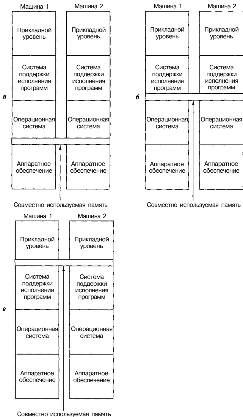
Рис. 8.3. Уровни, на которых можно реализовать память совместного использования: аппаратное обеспечение (а); операционная система (б); программное обеспечение (в)
