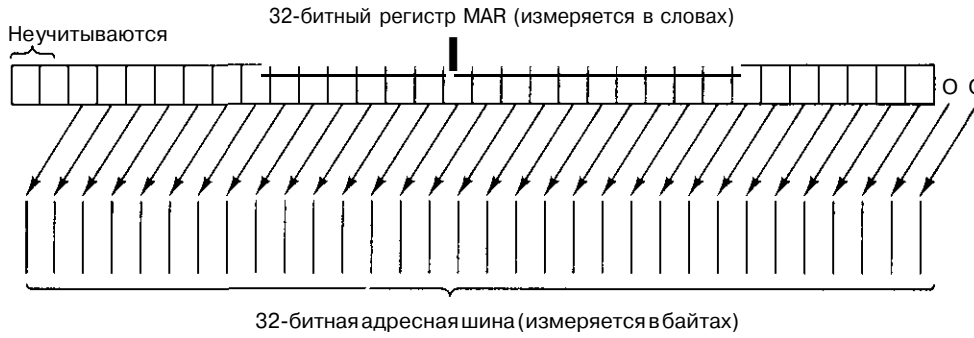
Рис. 4.3. Распределение битов регистра MAR в адресной шине
