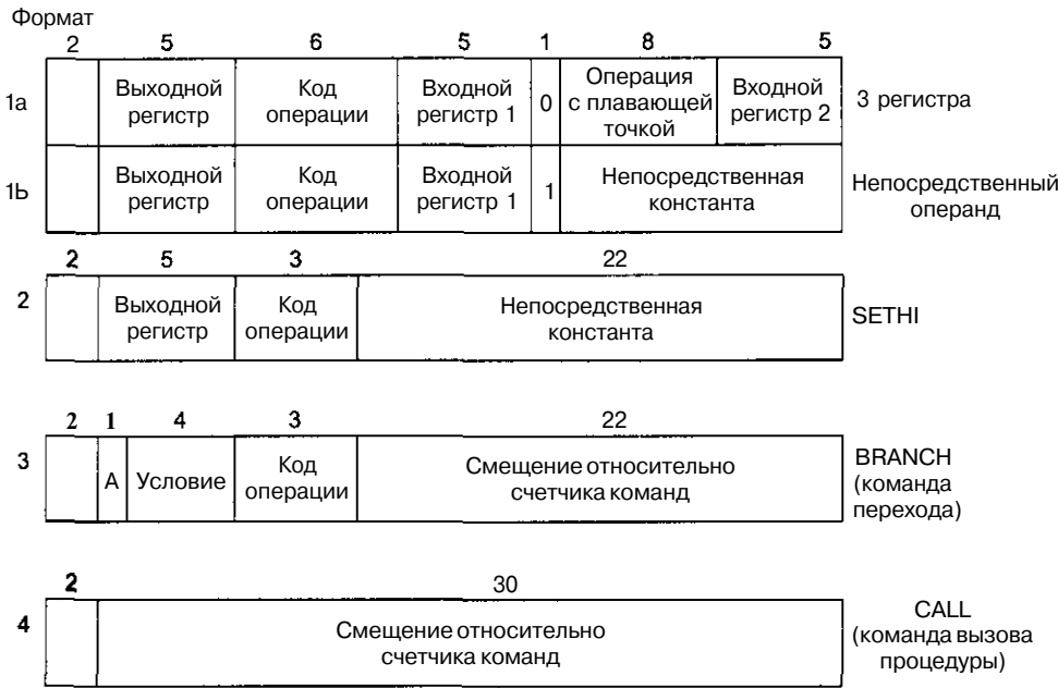
Рис. 5.10. Изначальные форматы команд процессора SPARC
