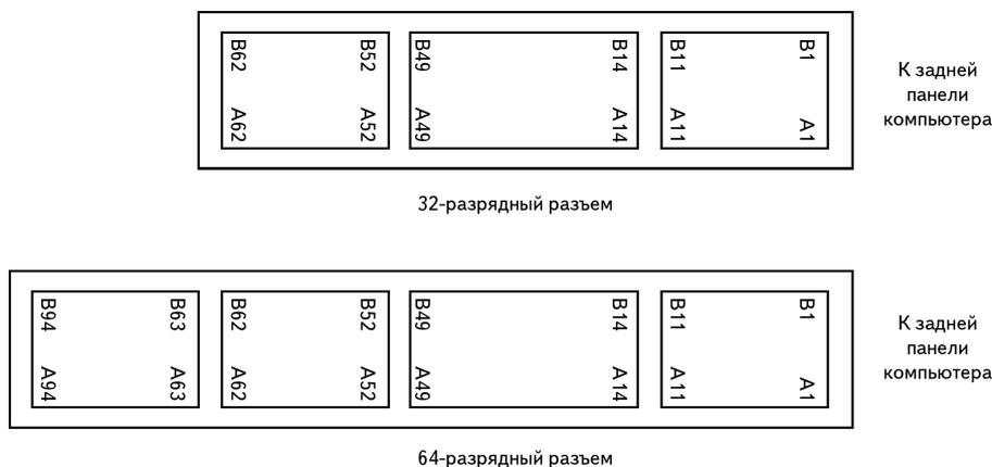
Рис. 4.34. Разъемы универсальной шины PCI
