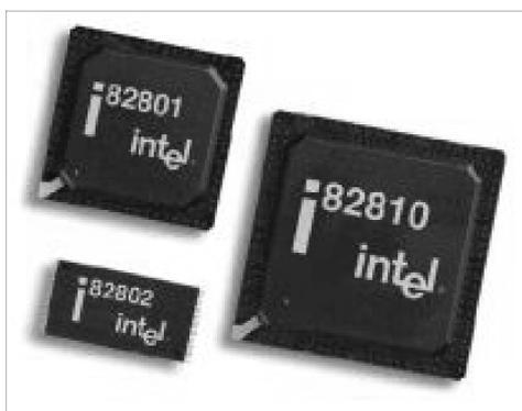
Рис. 4.22. Микросхемы 82810 (GMCH), 82801 (ICH) и 82802 (FWH) набора микросхем системной логики Intel 810. Фото публикуется с разрешения фирмы Intel
