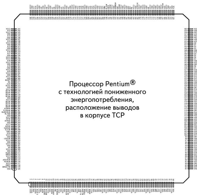
Рис. 23.7. Расположение выводов мобильного процессора Pentium MMX в корпусе TCP
