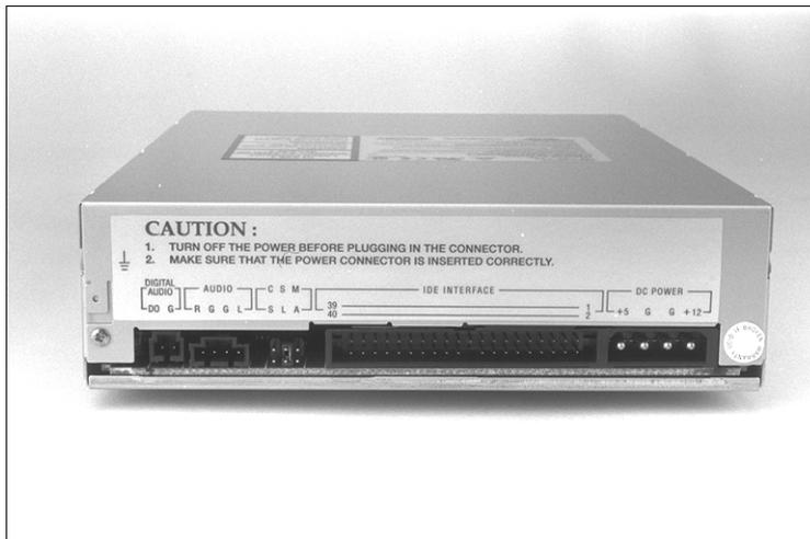
Рис. 14.4. Задняя сторона типичного накопителя CD-ROM с интерфейсом IDE
