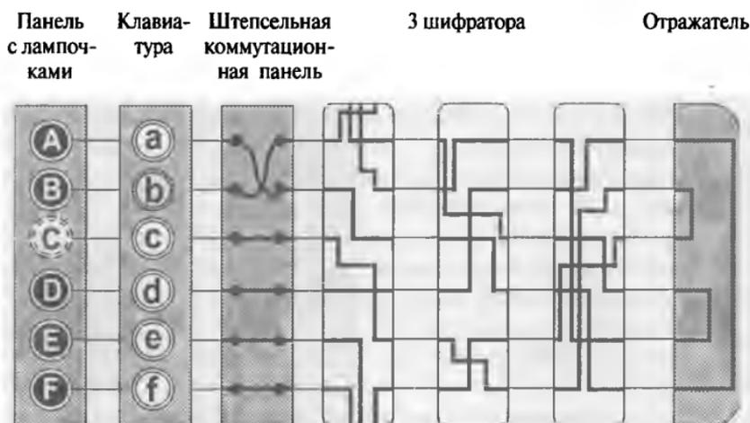
**Рис. 37** Штепсельная коммутационная панель устанавливается между клавиатурой и первым шифратором. Вставляя кабели, можно переставлять местами пары букв; в нашем случае **b** меняется местами с **a**. Теперь зашифровывание **b** производится по пути, по которому прежде происходило зашифровывание **a**. При работе на реальной «Энигме», использующей алфавит с 26 буквами, у пользователя имелось шесть кабелей, позволяющих осуществлять перестановку в шести парах букв.
