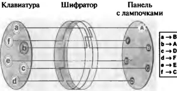
Рис. 33 Упрощенный вариант «Энигмы» с алфавитом, состоящим всего из шести букв. Самым важным элементом машины является шифратор. При наборе на клавиатуре буквы **b** ток поступает в шифратор, проходит по проводам внутри него, а затем зажигает лампочку **A**. Короче говоря, **b** зашифровывается как **A**. Справа в прямоугольнике показано, как зашифровывается каждая из шести букв.
