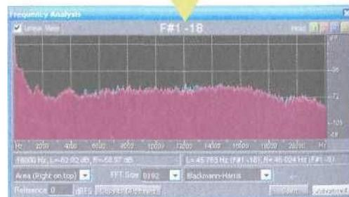
Осциллограмма, звуковой дорожки, сжатой с битрейтом 256 kbps
