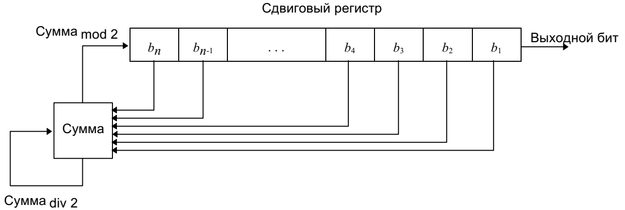
Рис. 17-3. Сдвиговой регистр с обратной связью по переносу.
